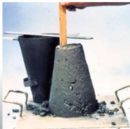
Измерение величины осадки конуса поставляемого бетона
