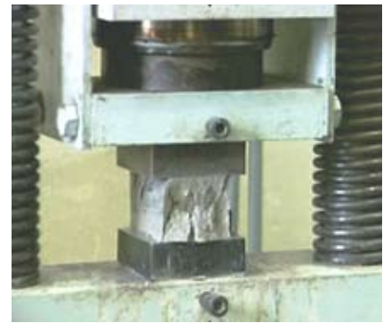
Испытание контрольных образцов бетона на сжатие
