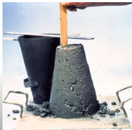
Измерение величины осадки конуса поставляемого бетона
