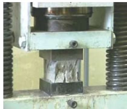
Испытание контрольных образцов бетона на сжатие
